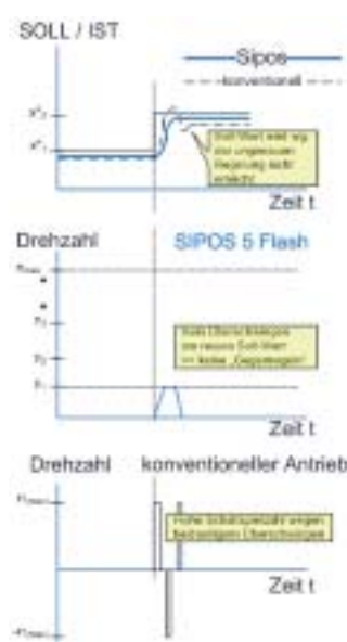
Fig. 5 Visning af den faktiske værdi ("spring-melding") ved SIPOS' adaptive stillingsregulator og ved det konventionelle drev. Nedenunder forløbet af de respektive omdrejningstal.
