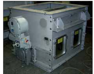
Bild 3: Schonung der Armatur – und in diesem Fall sicher auch der Ohren: Große Abfüllklappe einer Düngemittelfabrik mit SIPOS-Schwenkantrieb
