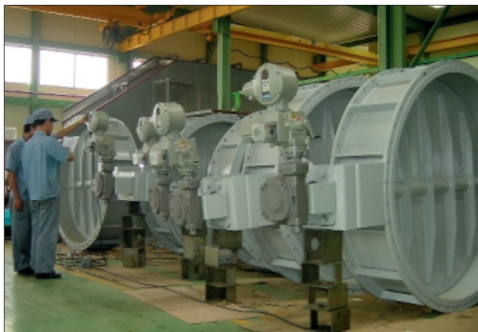
Bild 5: Klappen DN 1800, PN 1,6 mit drehzahlveränderbarem Antrieb für die Regelung der Luftzufuhr an einem Stahlwerksofen
