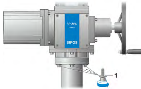
Fig. 1: montaggio dell'attuatore all'unità lineare
