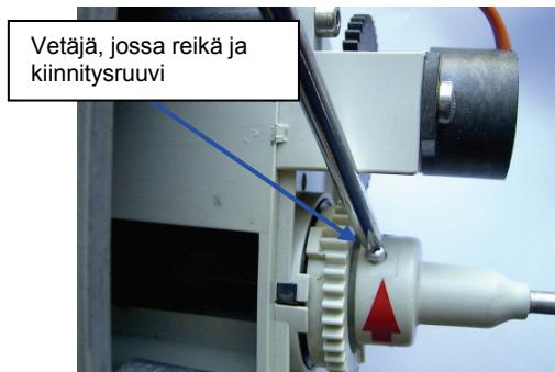
Kuva 1: Ilmoitusvaihteisto ja vetäjä ja kiinnitysruuvi
