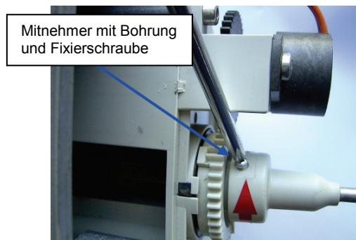
Abb. 1: Meldegetriebe mit Mitnehmer und Fixierschraube
