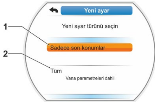
Şekil 2: Parametrelili veya parametresiz olarak son konumların ayarlanması
