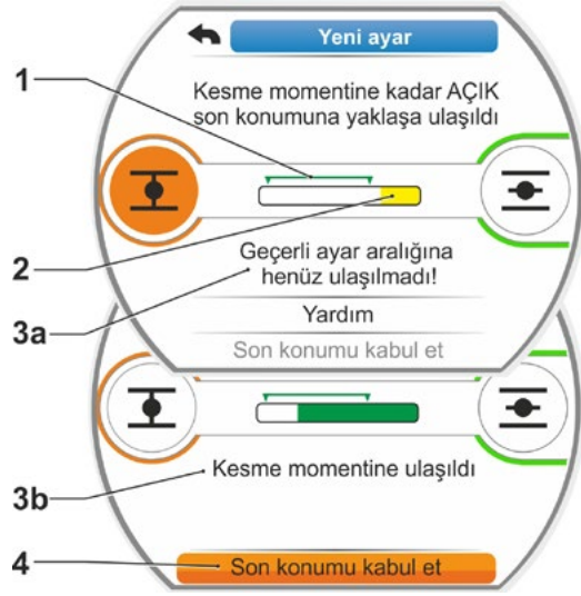
Şekil 12: Torka bağlı kesmede KAPALI son konumuna hareket etme
