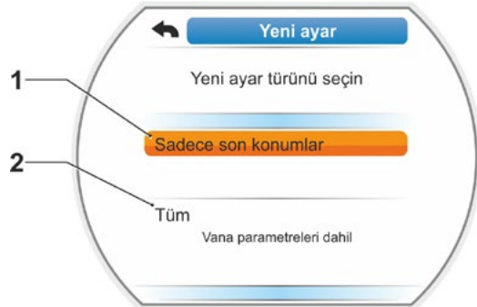
Şekil 2: Parametrelili veya parametresiz olarak son konumların ayarlanması
