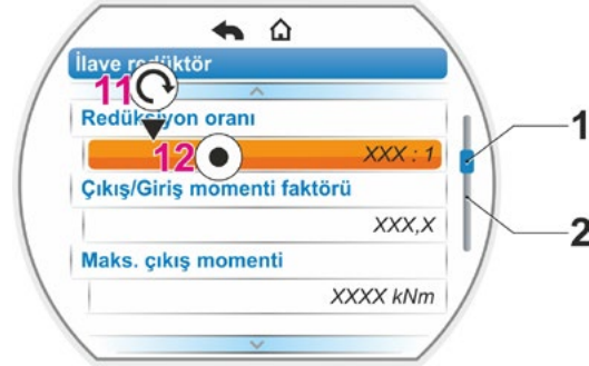
Şekil 2: 'İlave redüktör' menüsündeki parametreler
