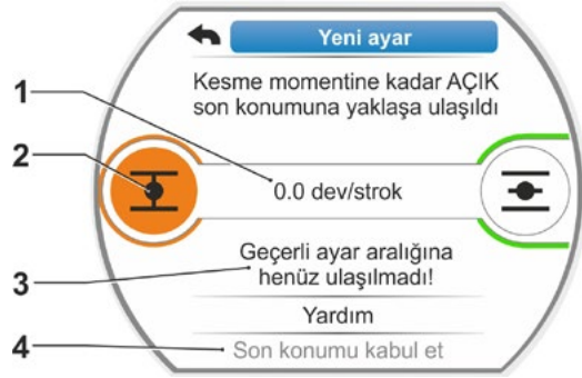
Şekil 6: KAPALI son konumuna hareket et
