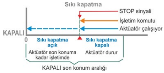
Şekil: Sıkı kapatma fonksiyon prensibi
