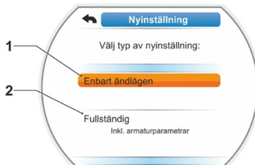
Bild 2: Ändlägesinställning med eller utan parametrar
