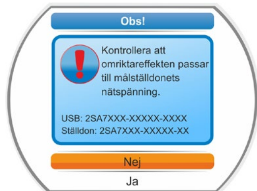
Bild 2: Information: Kontrollera omriktareffekt och nätspänning
