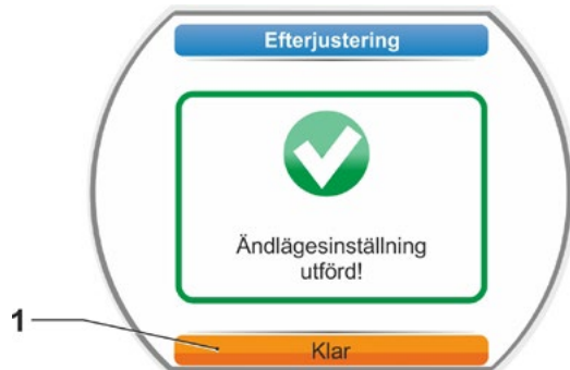
Bild 4: Efterjustering av ändläge korrekt
