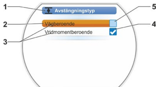
Bild: Inställningsmeny Avstängningstyp ändläge STÄNGD
