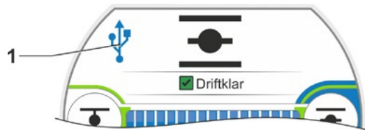
Bild 2: Visning på displayen: kommunikation via USB
