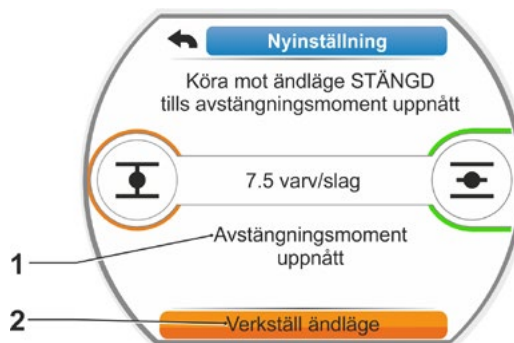
Bild 7: Ändläge STÄNGD nått
