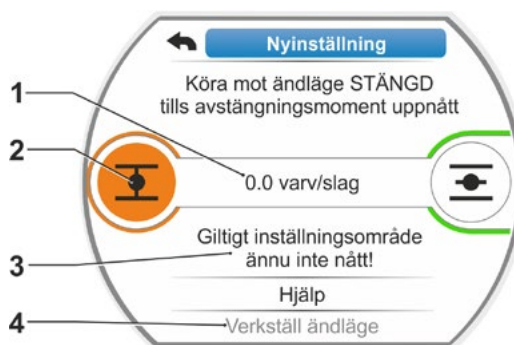
Bild 6: Kör mot ändläge STÄNGD
