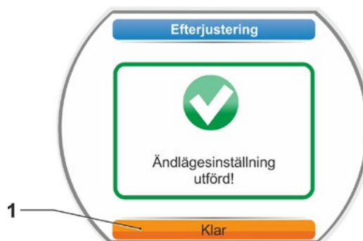
Bild 5: Efterjustering av ändläge korrekt
