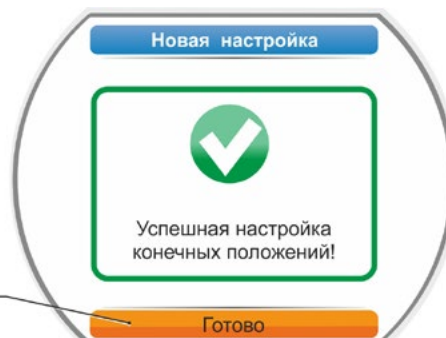
Рис. 13: Настройка конечного положения правильная
