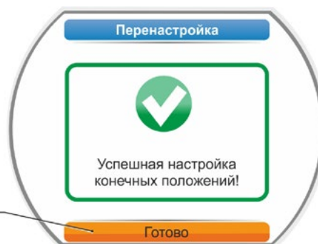
Рис. 4: Перенастройка конечного положения правильная
