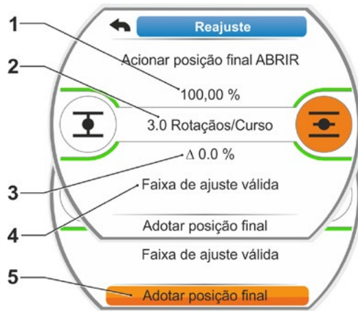
Fig. 3: Acionar e adotar nova posição final
