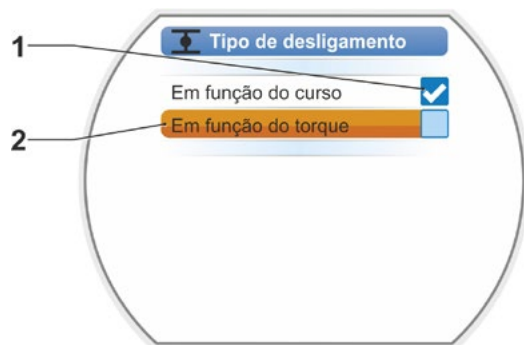
Fig.: Menu Ajustar tipo de desligamento na posição final FECHAR
