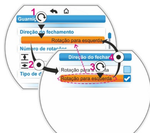
Fig.: Alterar propriedade de um parâmetro no menu Guarnição
