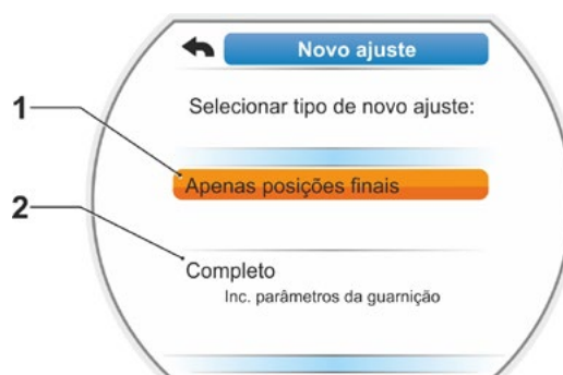
Fig. 2: Ajuste da região de posição final com ou sem parâmetros
