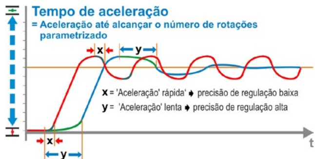
Fig.: Princípio do tempo de aceleração
