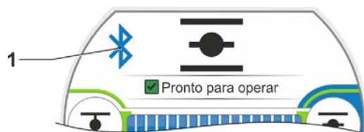
Fig.: Exibição no display: Comunicação pelo bluetooth
