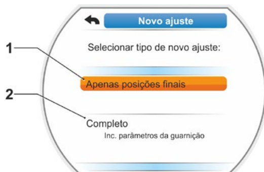
Fig. 2: Ajuste da região de posição final com ou sem parâmetros
