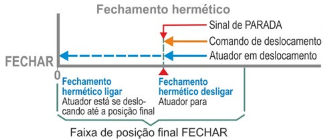
Fig.: Princípio do funcionamento do fechamento hermético
