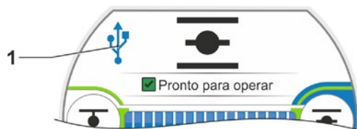
Fig. 2: Exibição no display: Comunicação pelo USB
