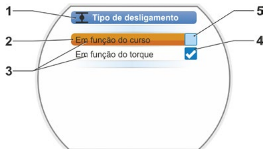
Fig.: Menu de ajuste tipo de desligamento da posição final FECHAR
