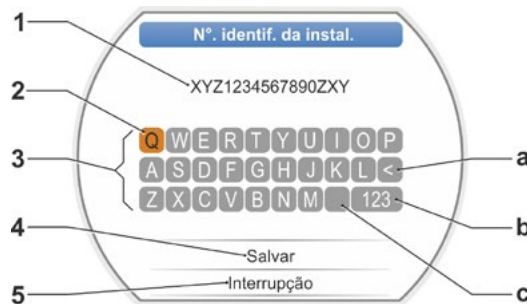
Fig. 2: Introdução do n. de identif. da instalação
