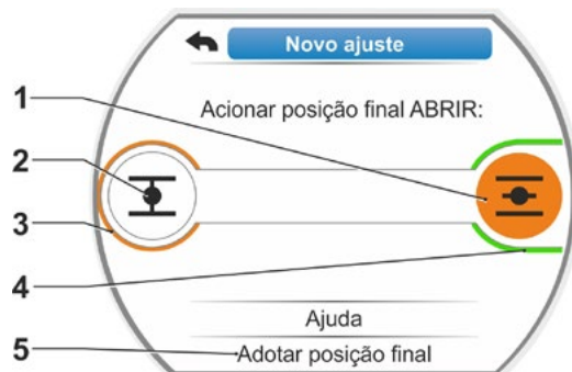
Fig. 4: Acionar posição final na direção ABRIR
