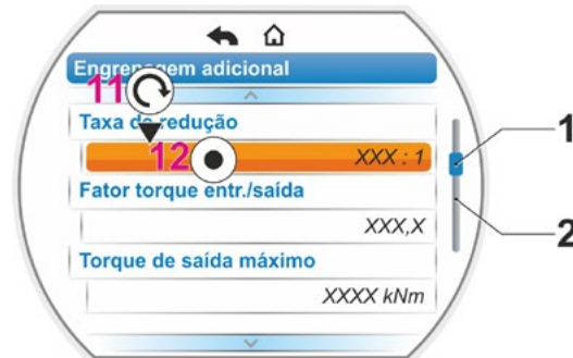
Fig. 2: Parâmetro no menu 'Engrenagem adicional'
