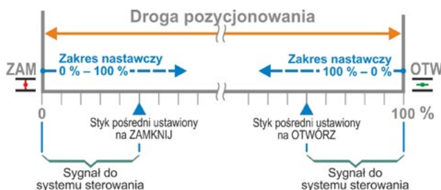
Rys.: Zasada działania styku pośredniego
