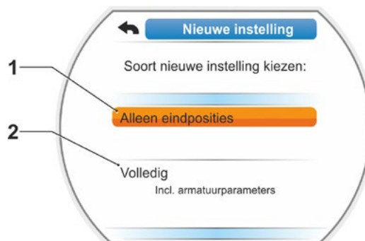
Afb. 2: eindpositie-instellingen met of zonder parameters
