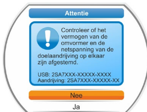
Afb. 2: opmerking: vermogen omvormer en netspanning controleren
