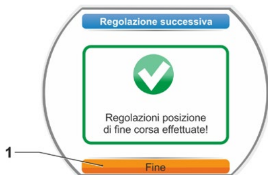
Fig. 4: Regolazione successiva corretta della posizione di fine corsa
