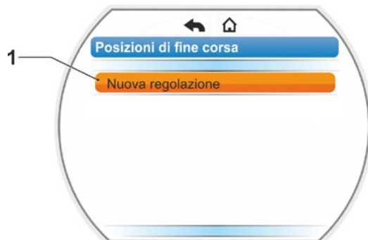
Fig. 1: Nuova regolazione delle posizioni di fine corsa
