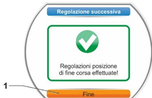
Fig. 5: Regolazione successiva corretta della posizione di fine corsa
