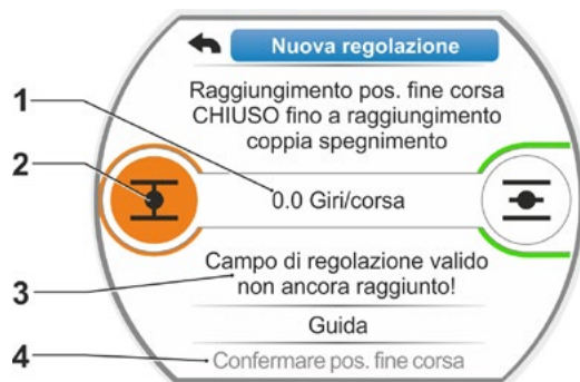
Fig. 6: Raggiungimento della posizione di fine corsa CHIUSO
