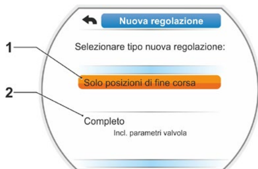
Fig. 2: Regolazione posizione di fine corsa con o senza parametri
