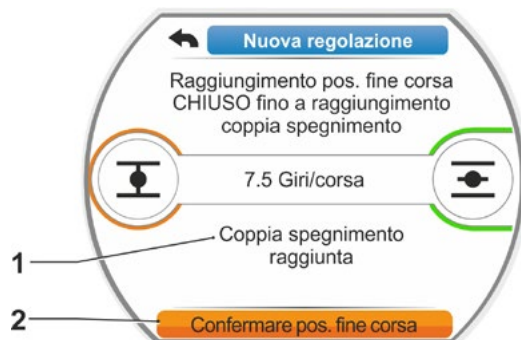
Fig. 7: Posizione di fine corsa CHIUSO raggiunta
