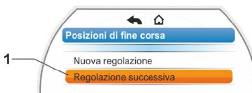
Fig. 1: Regolazione successiva delle posizioni di fine corsa
