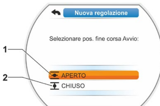
Fig. 5: Selezione della posizione di fine corsa
