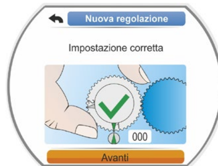
Fig. 9: L'impostazione della 1ª posizione di fine corsa è corretta
