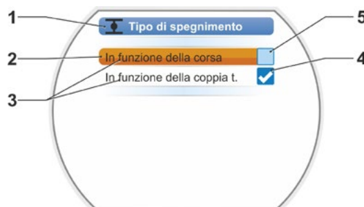
Fig.: Menu di impostazione tipo di spegnimento posizione di fine corsa CHIUSO
