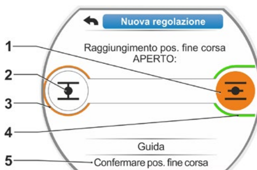
Fig. 6: Raggiungimento della posizione di fine corsa in direzione APERTO
