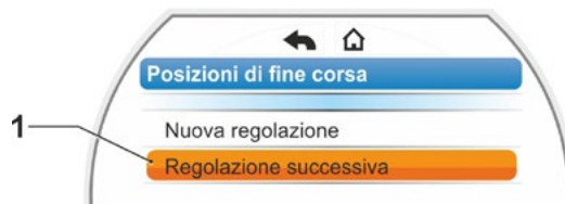
Fig. 1: Regolazione successiva delle posizioni di fine corsa
