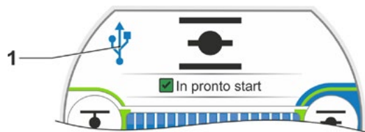
Fig. 2: Visualizzazione sul display: comunicazione tramite USB
