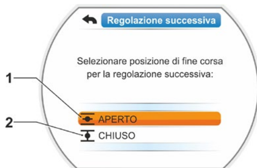
Fig. 2: Selezione della posizione di fine corsa
