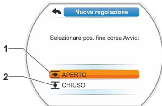
Fig. 3: Selezione della posizione di fine corsa
