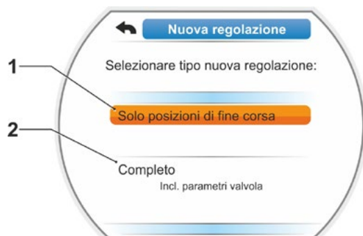
Fig. 2: Regolazione posizione di fine corsa con o senza parametri
