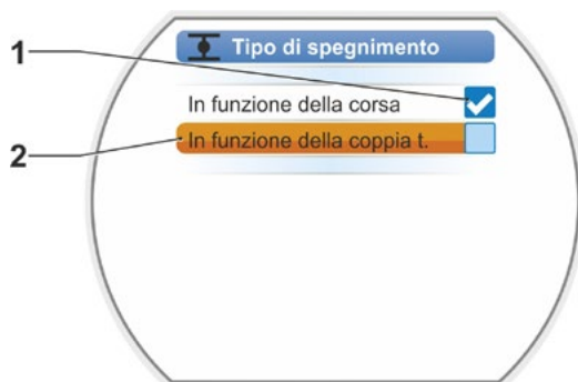
Fig.: Menu Impostazione del tipo di spegnimento in posizione di fine corsa CHIUSO
