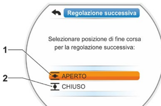
Fig. 2: Selezione della posizione di fine corsa
