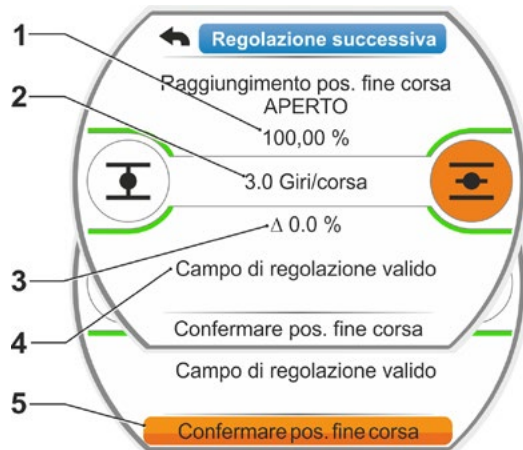
Fig. 3: Raggiungimento e salvataggio della nuova posizione di fine corsa
