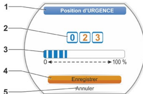
Fig. : modifier la valeur numérique
