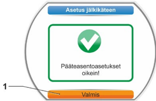
Kuva 4: Pääteasennon jälkiasettelu oikein
