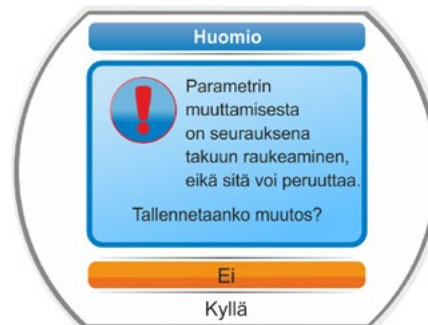
Kuva: Moottorinsuojaukseen liittyvä varoitus
