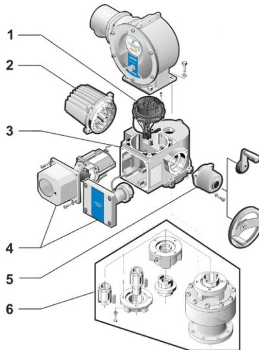
Fig.: Gear unit sub-assemblies
