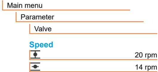
Fig. 1: Navigation to ‘Speed’ parameter
