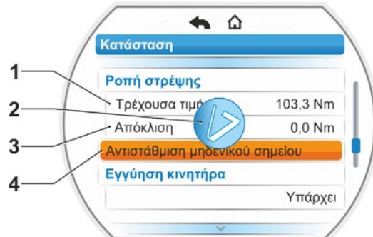
Εικ.: Μενού Αντιστάθμιση μηδενικού σημείου ροπής στρέψης
