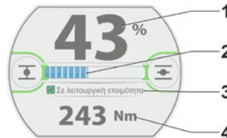
Εικ. 4: Ένδειξη αναμονής [Standby] «Θέση+Πλήρωση+Κατάσταση»
