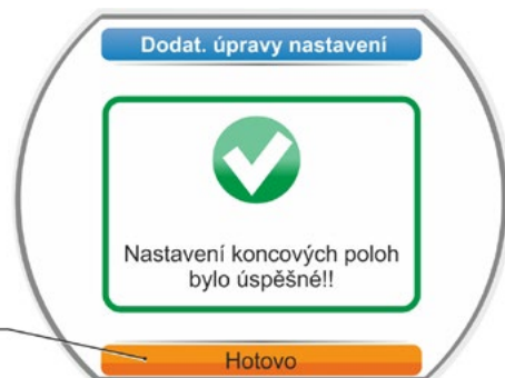
Obr. 4: Dodatečné úpravy koncové polohy jsou správné
