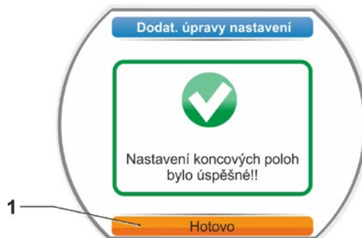
Obr. 5: Dodatečné úpravy koncové polohy jsou správné
