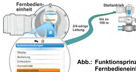
Abb.: Funktionsprinzip Fernbedieneinheit
