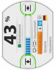
Wird bei der Einstellung „Schnellumschaltung Ort“ im Standby-Zustand der Drive Controller gedrückt, schaltet der Antrieb
