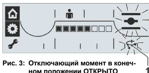
Рис. 3: Отключающий момент в конечном положении ОТКРЫТО
