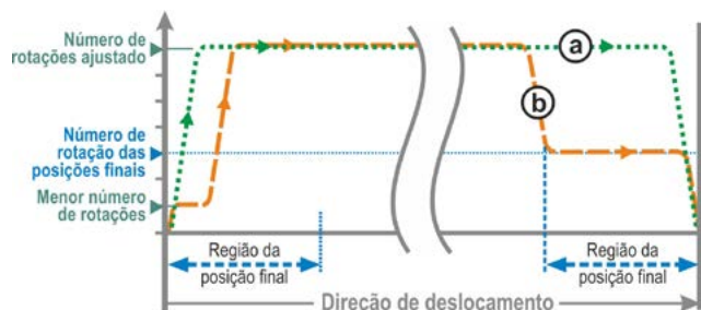
Fig. 3: Número de rotação de posição final 'partida/parada rápidas'
