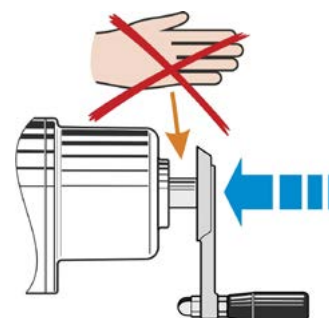
Fig.: Perigo de esmagamento
