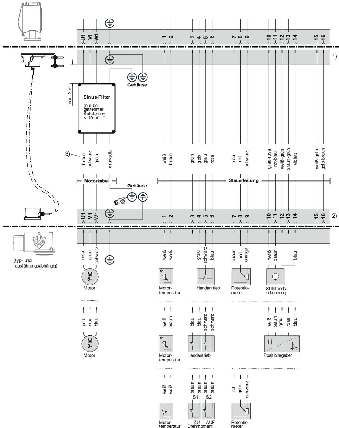
PE-Leitung muss wie abgebildet am Gehäuse angeschlossen sein!
