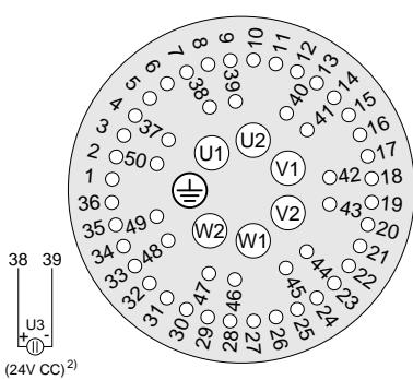
1) áreas isoladas galvanicamente: podem ser alimentadas por diferentes fontes de tensão com 24/48V CC
